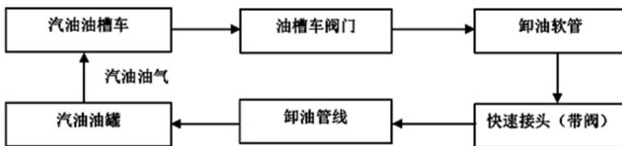
图 2.6-1 乙醇汽油卸油及油气回收工艺流程示意图
