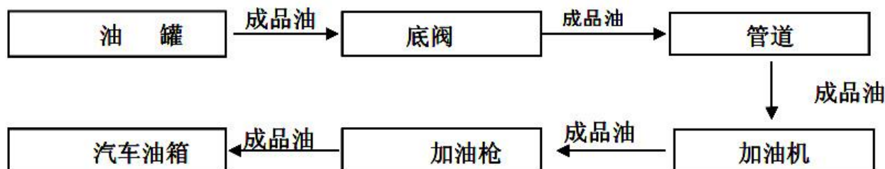
图 2.6-3 柴油加油工艺流程示意图
