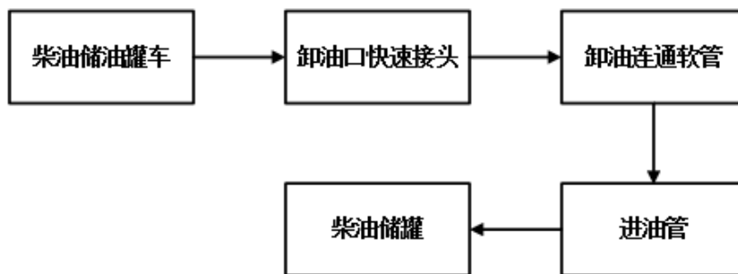
图 2.6-2 柴油卸油流程图
