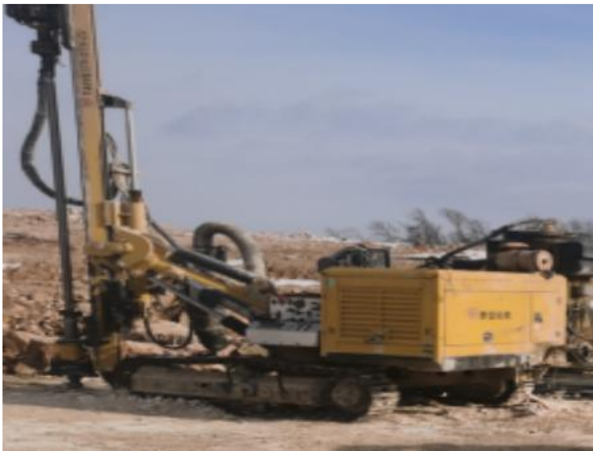
图 2.5-3 潜孔钻机现场照片
