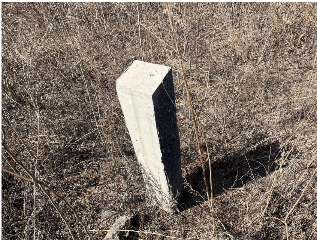
图 2.7-1 位移监测设施
